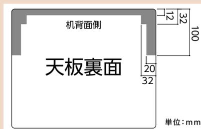
取り付けのためにはデスクの天板裏面に、上図の灰色の形状のスペースが必要です。さらに天板厚:18~20mm、天板幅:600mm/650mmが取り付け条件となります。
